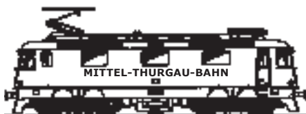
Re 4/4 II 21, Baujahr 1969, Vmax 140 km/h LÜP 15'410 mm, Leistung 4650 kW
