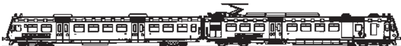
Neuer Pendelzug (NPZ «Seehas»): RBDe 4/4 566 631–634, Baujahr 1994, Vmax 140 km/h, LÜP 25'000 mm, Leistung 1650 kW + Bt 211–216
