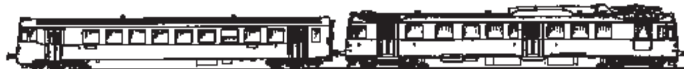
Pendelzug 1965: ABDe 4/4 11–16, Baujahr 1965, Vmax 100 km/h, LÜP 24'300 mm, Leistung 1095 kW + Bt 201–204
